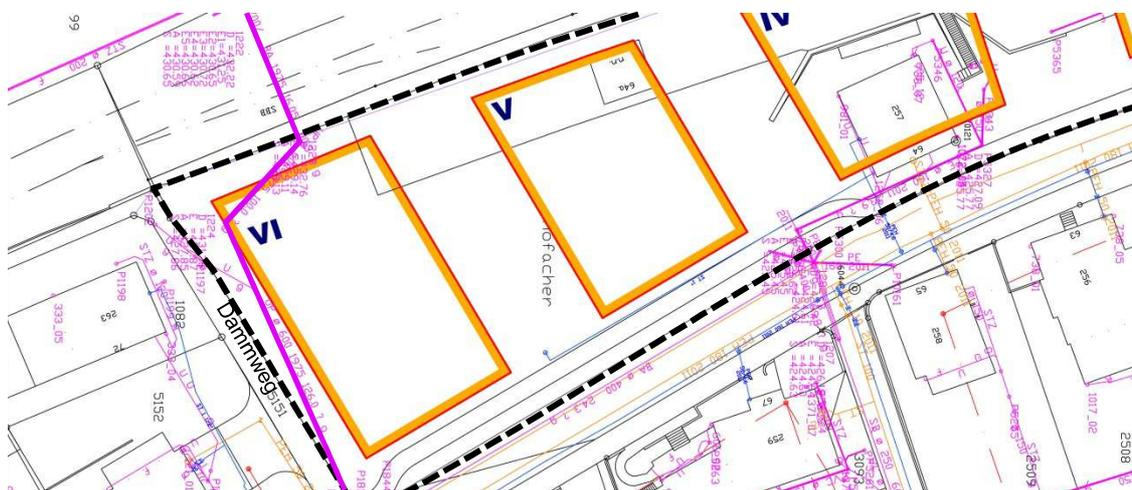
Abbildung 6 Bestehende Kanalisationsleitung im Baubereich VI (Q: BC AG)
